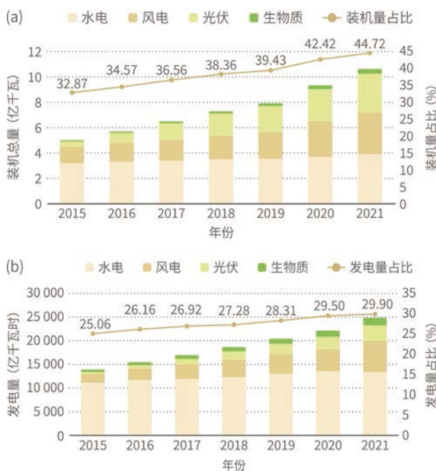
图 4-3. 中国可再生能源电力装机及占比 (a) 和中国可再生能源电力发电量及其在全社会用电量的占比 (b)
